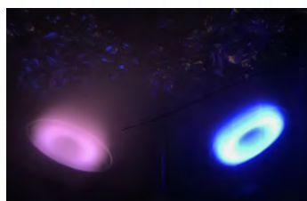
抗菌コーティング装置内部のプラズマによる固体原料の分解の様子(右:炭素、左:銅)
