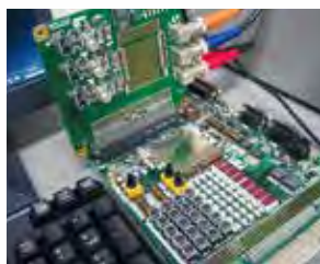
電子顕微鏡の信号処理システム
