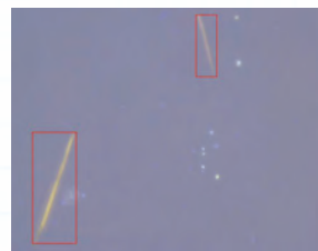
アスベスト検出の例 (赤い枠で囲われた部分が自動的に検出されたアスベスト)
