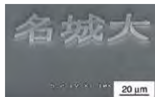
垂直に立つカーボンナノチューブの 絨毯を選択成長させて作った文字
